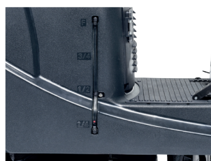
Indikátor úrovně vodního roztoku viditelný na nádrži
